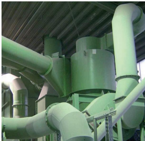
La structure des cyclones est simple, robuste, peu coûteuse et leur fonctionnement est facile d'entretien.
